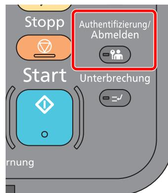
Wenn Sie sich am Gerät abmelden möchten, wählen Sie die Taste [**Authentifizierung/Abmelden**]. Die Anzeige zur Eingabe des Login-Benutzernamens und des Passworts wird wieder eingeblendet.
