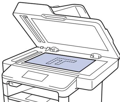
3. Legen Sie die Ecke der Seite in die obere linke Ecke des Scannerglases.
