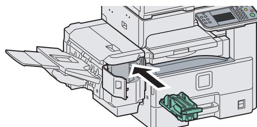
Der Heftklammerhalter rastet ein, wenn er korrekt eingesetzt wird.
