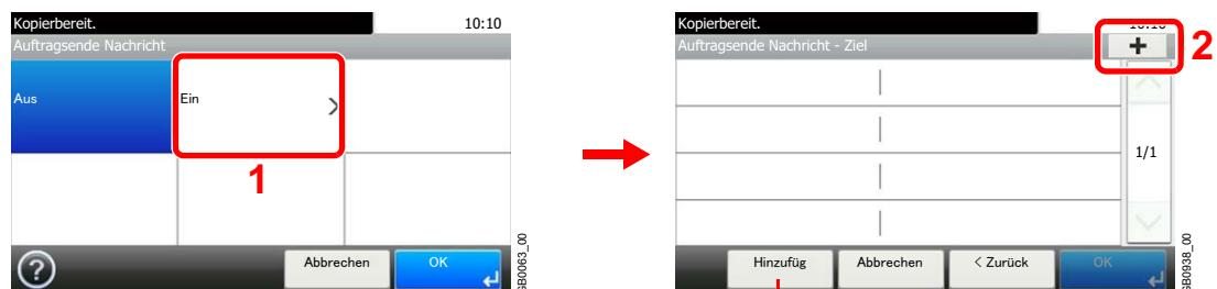
Ermöglicht das Hinzufügen, Ändern oder Löschen eines Ziels.
