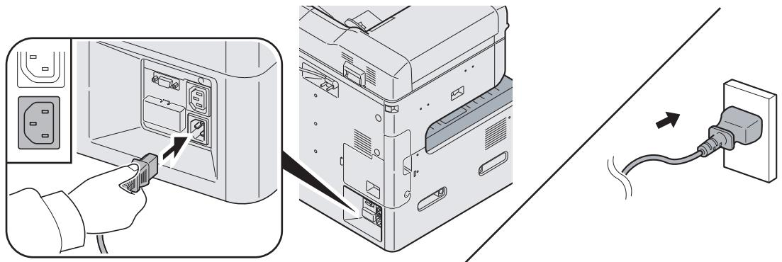
Schließen Sie ein Ende des mitgelieferten Netzkabels am Gerät und das andere Ende an einer Wandsteckdose an.
