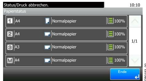
Der verfügbare Papervorrat wird in vier Schritten von 100%, 70%, 30% und 0% (leer) angezeigt. Die Universalzufuhr wird nur in zwei Schritten, 100% und 0%, angezeigt. Ist eine der Papierquellen leer, wird der Status *Pap. aus* angezeigt.
