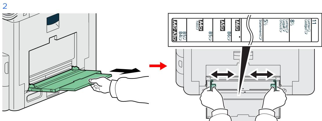
Bei Verwendung von A3 bis B4 Papier oder Ledger bis Legal, ziehen Sie die Ablageverlängerung aus der Universalzufuhr.
