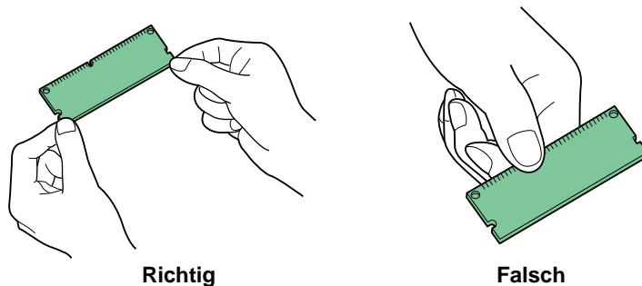
Um die elektronischen Bauteile zu schützen, muss die am Körper angesammelte statische Elektrizität abgeleitet werden, indem ein Wasserrohr oder ein anderes Metallobjekt berührt wird, bevor Sie die Speichermodule berühren. Während der Arbeit sollten Sie möglichst ein Antistatik-Armband tragen.
