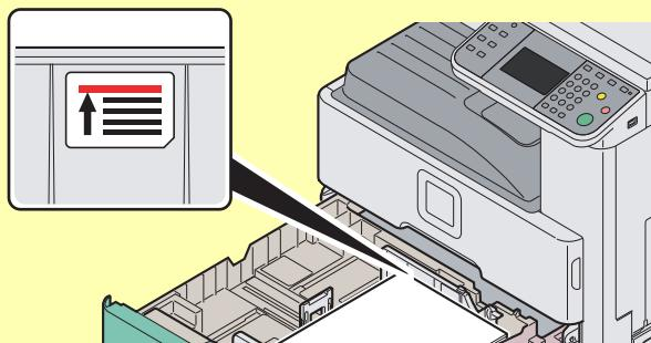
**Wenn Sie das Papier einlegen, achten Sie darauf, dass die Seite nach oben zeigt, die auf der Verpackung mit einem Aufwärtspfeil angezeigt wird.**
