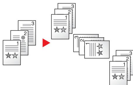
Diese Funktion versetzt die Sätze oder Seiten, indem jede Ausgabe um 90° gedreht ausgegeben wird.
