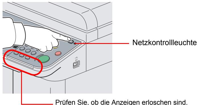
Überzeugen Sie sich, dass die Kontrollleuchte der **Power** Taste erloschen ist und die Netzkontrollleuchte aufleuchtet.
