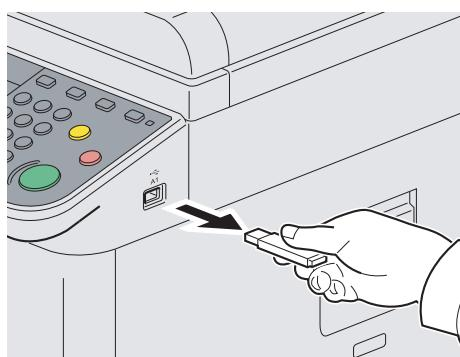
Nachdem *Externer Speicher sicher entfernbar* angezeigt wird, tippen Sie auf [OK] und entfernen Sie den USB-Speicher.
