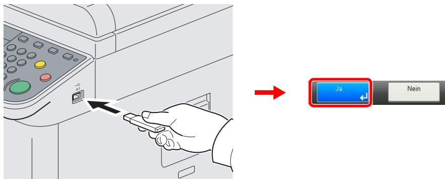
Setzen Sie den USB-Speicher direkt in den Einschub (A1).
