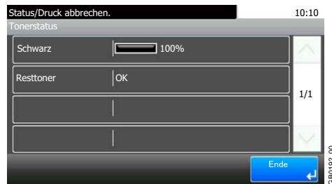
Die verfügbare Tonermenge wird in 11 Segmenten von 100% bis 0% angezeigt. Außerdem wird der Status des Resttonerbehälters angezeigt.
