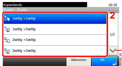
Bei Auswahl von 2-seitig Blatt oder Buch, fahren Sie mit Schritt 3 fort. Bei Auswahl von Duplex fahren Sie mit Schritt 4 fort. Bei Auswahl von [Buch]>>2-seitig fahren Sie mit Schritt 5 fort.
