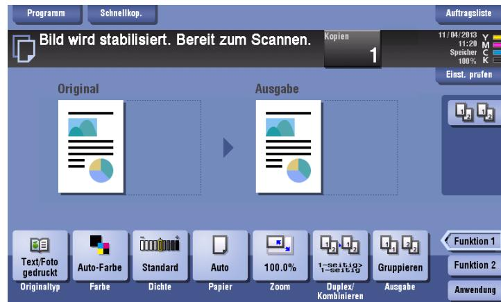
Bildstabilisierung wird durchgeführt, wenn eine große Anzahl von Kopien ausgegeben wird oder wenn die Temperatur oder Luftfeuchtigkeit im System sich verändert hat.
